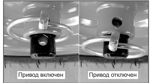
Рис.10 Перестановка шплинта на левом колесе
