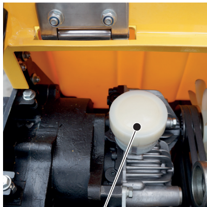
Крышка бачка гидравлической системы
