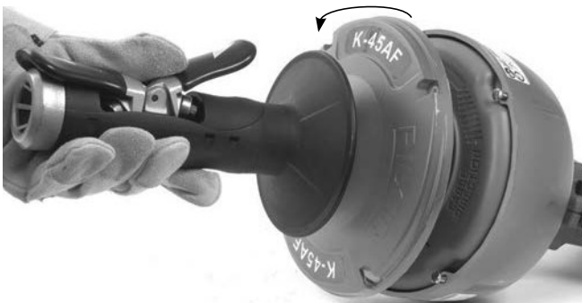
Рис. 14 – Проверните и разъедините крышки барабана
