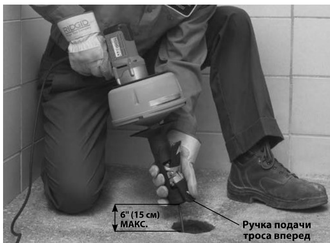
Рис. 10 – Подача троса с помощью устройства AUTOFEED
