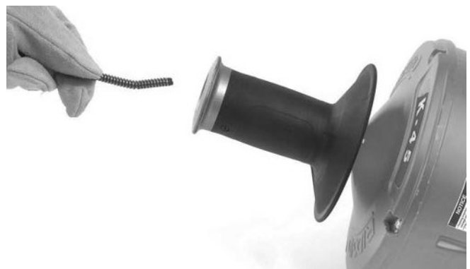
Рис. 17 – Заправка троса без замены внутреннего барабана
