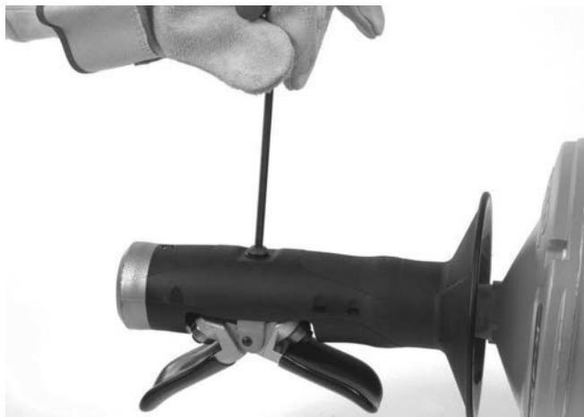
Рис. 12А – Отворачивание винта крепления устройства автоподачи AUTOFEED
