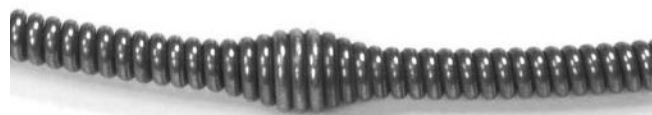
Рис. 11 – Трос C-13-IC SB с индикатором конца троса. Ограничитель скорости находится примерно на расстоянии 84" (2,1 м) от задней оконечности троса
