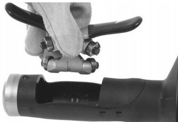
Рис. 12В – Снятие с корпуса устройства автоподачи AUTOFEED
