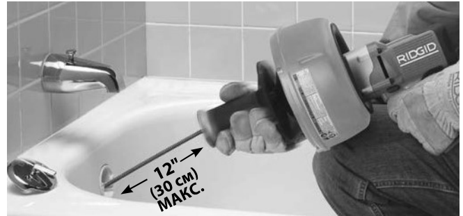
Рис. 8 – Переместите рукоятку к барабану, чтобы захватить трос зажимным патроном
