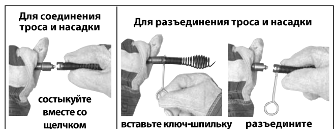
Рис. 7 – Подсоединение и отсоединение насадок
