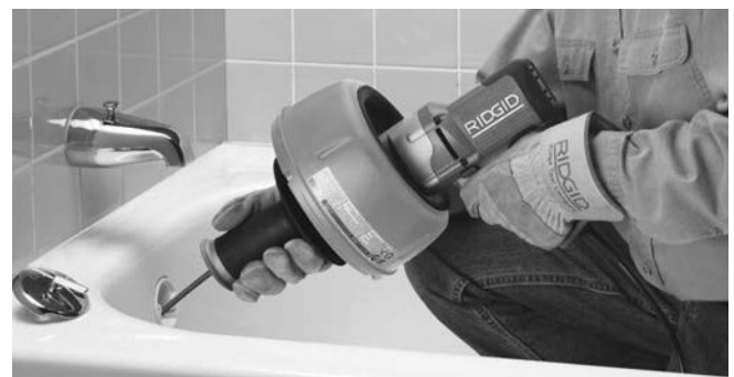
Рис. 9 – Протолкните трос дальше в канализационную трубу
