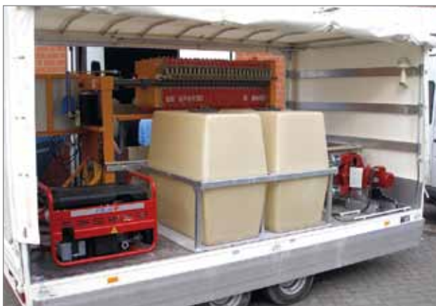
слева: генератор тока, баки очищенной воды, шламный насос
