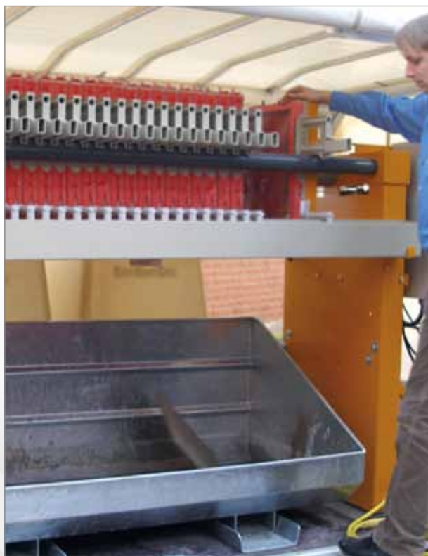
Для опорожнения фильтров нужно растянуть фильтрующие элементы.
