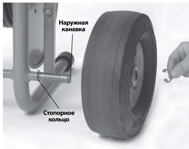
Рис. 4 – Сборка установки KJ-2200
