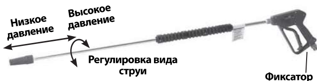
Рис. 17 – Регулировка моющей насадки
