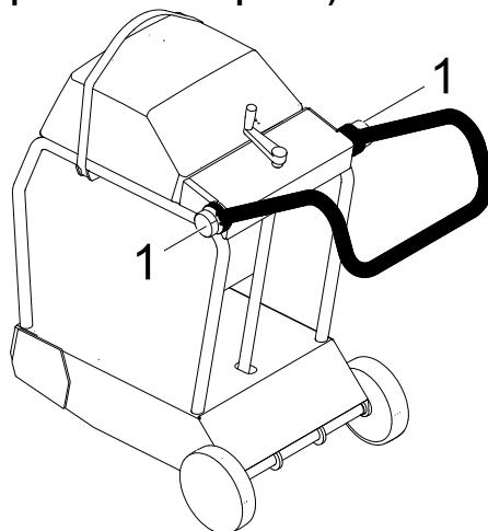
В зависимости от роста пользователя и конкретного применения дугообразная рукоятка может быть установлена по высоте.
