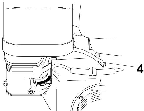
Когда двигатель прогрет, то рычаг привода воздушной заслонки постепенно установить в положение OPEN. Ручкой газа (4) установить необходимое число оборотов двигателя.
