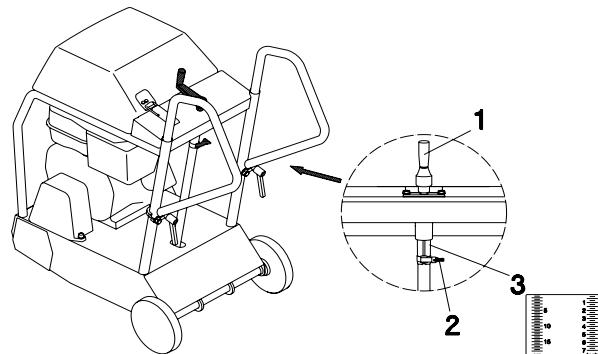
Установленную глубину реза можно контролировать с помощью шкалы. На нее нанесены единицы длины в см и дюймах. Для получения правильной величины она должна быть отрегулирована в соответствии с конкретным диаметром режущего диска. Для этого вращать рычаг (1), пока диск не коснется земли, ослабить зажим (2) и двигать наверх втулку (3) с наклеенной шкалой до нижнего края втулки. После этого опять затянуть зажим (2).
