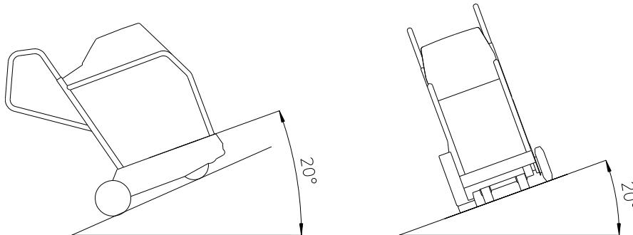
Максимально допустимое наклонное положение относительно плоскости двигателя.
