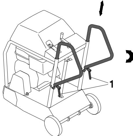
В зависимости от роста пользователя и конкретного применения рукоятки могут быть как отрегулированы по высоте, так и раздвинуты в стороны. Для этого ослабить зажимной рычаг (1) и снова закрепить в новом положении.
