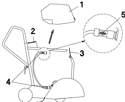
Шовнарезчик оснащен встроенным вынимаемым водяным баком (1).
