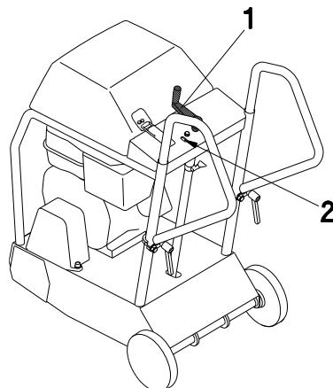
Глубина реза может быть точно установлена с помощью рычага (1). Один поворот рычага соответствует ровно 5 мм глубины реза. Поворот по часовой стрелке увеличивает, а поворот против часовой стрелки уменьшает глубину реза.
